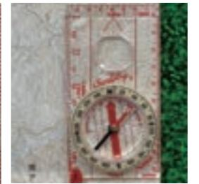
西偏7度に合わせる場合、回転リングを回して度数線に地形図の偏差角度を合わせます。
