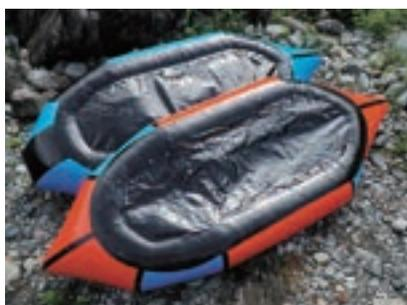
Shoconic-255 (奥) のフロアはボトム面が通常の流水モデル (手前・WW-255) よりも高めに取付けられた「ライズドフロア」となっている。これによって水抜けが良くなり、操作性の向上が図られている。
