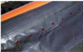
流水用のボトムにはセルフベイラー（中に入っても喫水までは排水される仕組み）と呼ばれる水抜き穴が開けられている。これのおかげで中に水が溜まることはない。
