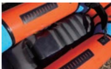
座り心地の良いシートと一体となった剛性を上げるフロアに、流水用にはしっかりと漕ぐためのバックレストやフットブレイス、そしてサイブレイスを取り付ける D 環も装備。
