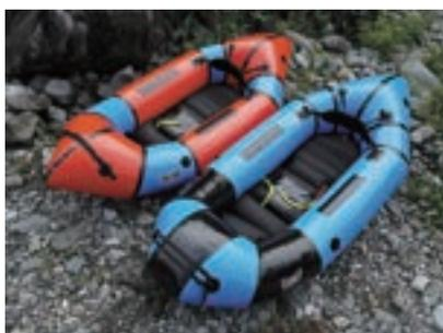
Shoconic-255 (手前) と通常の流水用モデルである WW-255 (奥) との全体的な比較。パウのとんがり無くしてボリュームをダウン、ロッカーも小さめにするにより、水上での取り回しがしやすいデザイン。
