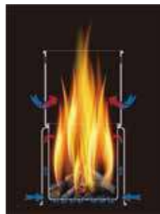
二次燃焼の仕組み
