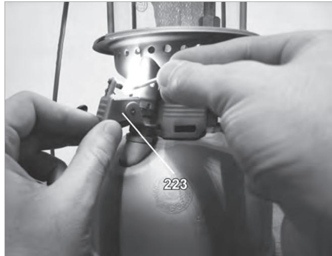
1. 予熱バーナーのレバー(223)を手前に押し下げるマッチで点火してください。予熱バーナーから炎が勢いよく噴射してジェネレーター(152)を熱しはじめます。
