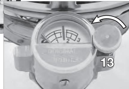
1. 圧力計の横についている圧力調整スクリュー(13)を反時計まわりに回すとタンクの圧力が抜けて自動的に消火します。
