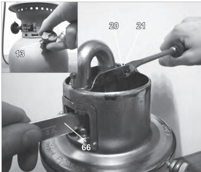
ニップル(50)から噴射したガスは空気と混合してミキシングチューブ(33)に入ります。十分な明るさが得られない時や燃焼が不安定な場合はガスの混合比が適切でない可能性がありますのでミキシングチューブの高さを以下の要領で調整してください。
