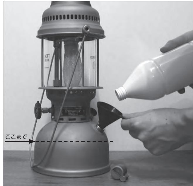
圧力計付注油口キャップ(149)を外し、付属のジョウゴ(65)を使って純良な灯油を入れてください。灯油の量はタンクの7分目を超えないようにしてください。燃料を入れ過ぎると圧力がかかりにくくなりますので注意してください。燃料が少なすぎると炎が途切れたり不安定な燃焼の原因となります。タンク内の注油量は目視で確認しながら入れてください。給油後は注油口キャップを取り付けてください。
